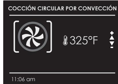
Compruebe que el reloj de tiempo real muestra la hora correcta. En el modo temporizado, el horno se apaga al finalizar el tiempo de cocción programado.
