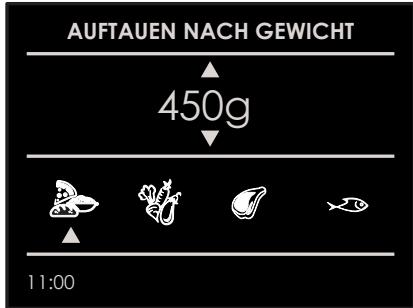
Die Art der Speise mithilfe der Pfeile  $\leftarrow$  und  $\rightarrow$  auswählen, dann das Gewicht mithilfe der Pfeile  $\Delta$  und  $\nabla$  eingeben, dann das Abtauen mithilfe der Taste starten.
