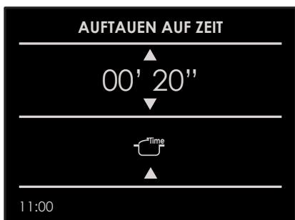
Läuft die Funktion, dann wird am Bildschirm ein Countdown angezeigt. Die Zeit kann jederzeit mithilfe der Pfeile  $\Delta$  und  $\nabla$  verändert werden. Ist das Abtauen beendet, dann erscheint am Bildschirm die Nachricht "ABTAUEN BEendet".
