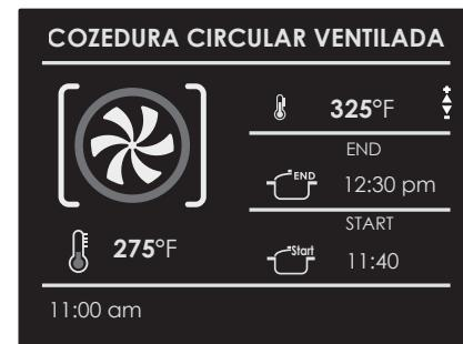
5 Após a cozedura, o forno desliga-se e um sinal acústico avisa que a cozedura terminou.
