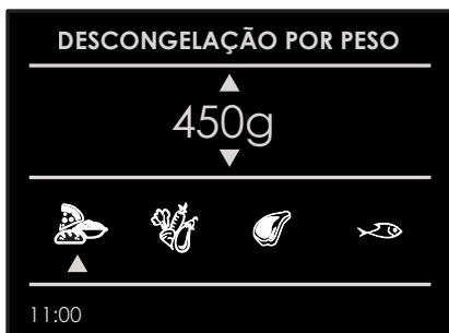
Selecione o tipo de metal usando as setas  $\triangleleft$  e  $\triangleright$ , depois defina o peso usando as setas  $\Delta$  e  $\nabla$  e, por fim, inicie o descongelamento usando a tecla **OK**.
