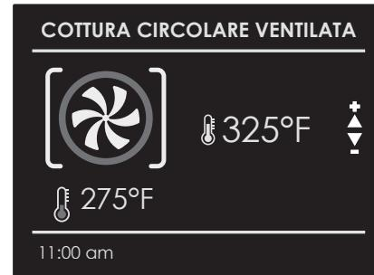
Non appena viene raggiunta la temperatura impostata, viene emesso un segnale acustico e la temperatura corrente scompare.
