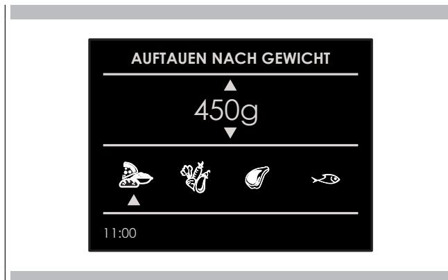
Die Art der Speise mithilfe der Pfeile  $\triangleleft$  und  $\triangleright$  auswählen, dann das Gewicht mithilfe der Pfeile  $\Delta$  und  $\nabla$  eingeben, dann das Abtauen mithilfe der Taste
