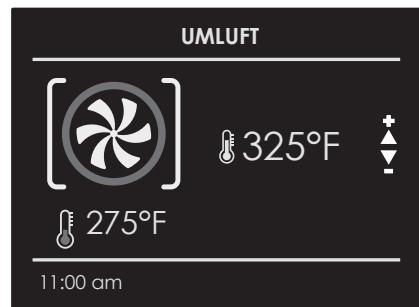
Sobald die Temperatur erreicht ist, erklingt ein akustisches Signal und die Temperaturanzeige verschwindet.
