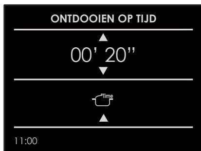
Als de functie is gestart, wordt de aflopende tijd getoond op het scherm. De tijd kan op elk moment gewijzigd worden met de pijlen  $\Delta$  en  $\nabla$ .
