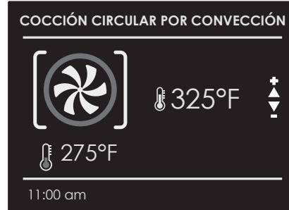
En cuanto se alcanza la temperatura configurada se produce una señal acústica y desaparece la indicación de la temperatura actual.
