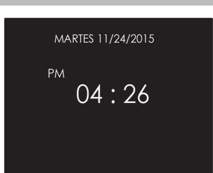
Con el horno encendido seleccione el icono y confirme con la tecla para entrar en el menú AJUSTES. Este menú permite personalizar los ajustes de su horno. Para poder acceder no debe haber cocciones activas o funciones con tiempo determinado configuradas.
