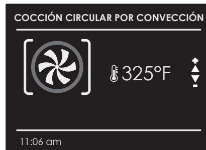
Compruebe que el reloj de tiempo real muestra la hora correcta. En el modo temporizado, el horno se apaga al finalizar el tiempo de cocción programado.
