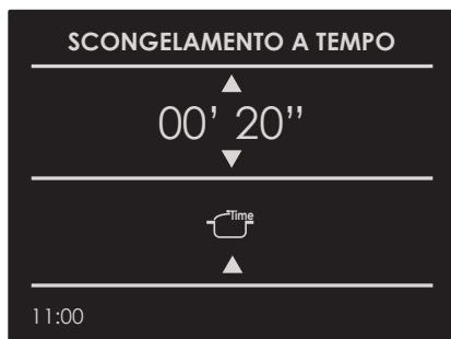
Una volta che la funzione è stata avviata, sul display verrà mostrato un conto alla rovescia. Il tempo può essere modificato in qualunque momento utilizzando le frecce  $\Delta$  e  $\nabla$ .
