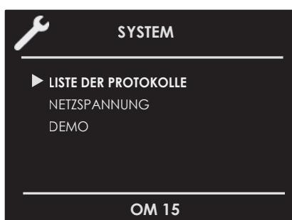
Mit dieser Funktion soll die Funktionsweise DEMO eingestellt werden, wodurch der Ofen nicht mehr benutzt werden kann, dieser aber automatisch einige Funktionen vorführt.
