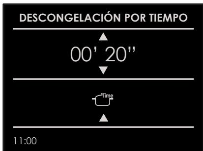
Al iniciar la función aparecerá una cuenta atrás en el display. El tiempo se puede variar en cualquier momento mediante las flechas  $\Delta$  y  $\nabla$ . Una vez completada la descongelación el mensaje "FIN DESCONGELACIÓN" aparecerá en el display.
