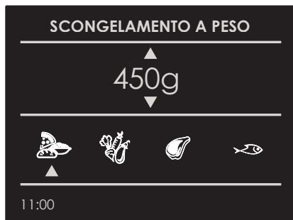
Selezionare il tipo di pasto utilizzando le frecce  $\Delta$  e  $\nabla$ , poi impostare il peso utilizzando le frecce  $\Delta$  e  $\nabla$ , infine avviare lo scongelamento utilizzando il tasto
